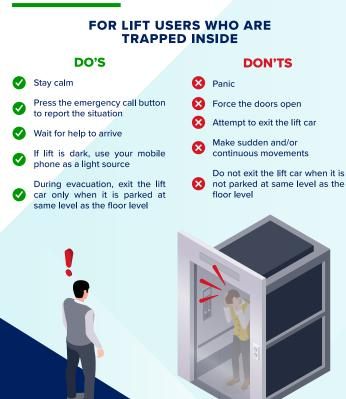
EMERGENCY LIFT ENTRAPMENT PROCEDURE TO RELEASE PASSENGERS TRAPPED INSIDE
